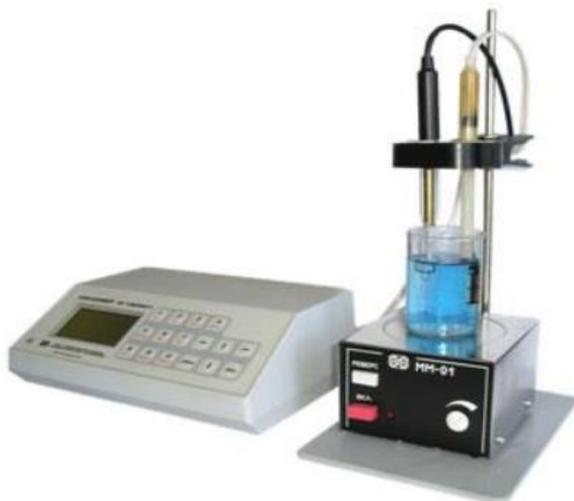
Рисунок 1. Внешний вид установки для потенциометрического титрования
